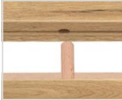
Stabile Verbindung mit Dübeln
