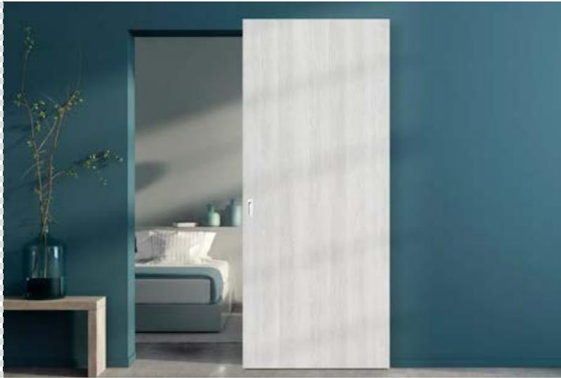
Das vor der Wand laufende Schiebetürsystem MAGIC ist ausschließlich zusammen mit einem Vollflügel MAGIC lieferbar. Der Flügel vom MAGIC besteht standardmäßig aus einer stabilisierenden Füllung „Wabeneinlage“ oder gegen Aufpreis aus Vollplatte. Der Flügel hat eine Kante ohne Falz. Das System ist nur für fertiggestellte Öffnungen geeignet und verfügt über keine Durchgangszarge.
